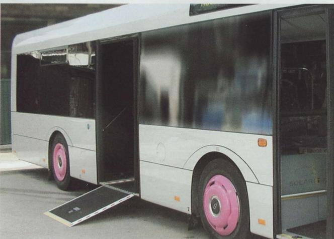
Barrierefreier Zugang. Die ausklappbare Rollstuhl-Rampe.
